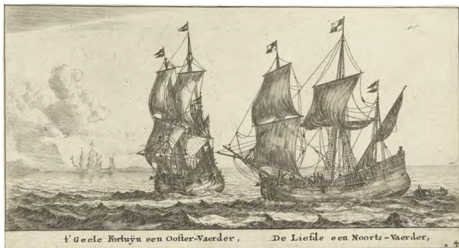
Figuur 9: Prent van een "Ooster-vaerder" (naar de Oostzee) en een "Noorts-vaerder" (naar Noorwegen, om hout). De Oostzeevaarder is een fluit, de Noordvaarder is een fluitachtige met aanpassingen om beter hout te kunnen laden. Vergelijk het aantal kanonnen en geschutspoorten in deze schepen met die op de Straatvaarder en de Fransvaarder in figuur 7: op 't Gele Fortuyn zijn er vier te zien, op de Liefde is geen enkele aanwijzing voor een bewapening met kanonnen. Prent van Reinier Nooms (circa 1623-1664), gedateerd 1652-1654 (bron: Rijksmuseum, http://hdl.handle.net/10934/RM0001.COLLECT.39783 ).
