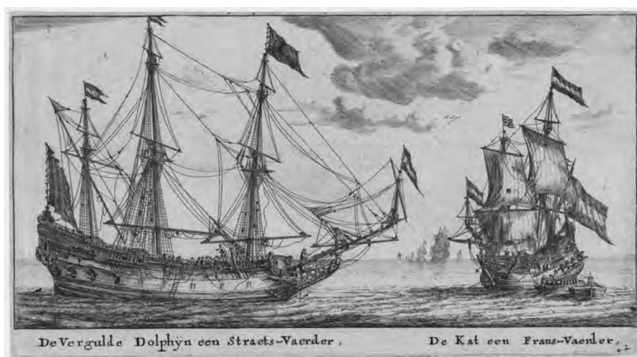
Figuur 7: Prent van een “straets-vaerder” en een “Frans-vaerder”. De Straatvaarder is een pinas, de Fransvaarder (varend op de bocht van Frankrijk om wijn) is een fluit, herkenbaar aan zijn peervormige kont. Let op het aantal kanonnen en geschutspoorten in beide schepen: alleen al elf aan stuurboord van de Vergulde Dolfijn en acht aan bakboord van de Kat . Prent van Reinier Nooms (circa 1623-1664), gedateerd 1652-1654 (bron: Rijksmuseum, http://hdl.handle.net/10934/RM0001.COLLECT.39783 ).
